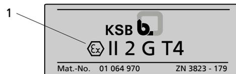
Ilustración 3: Ejemplo: Señal de tipo adicional en bombas protegidas contra explosiones
